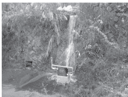
12月8日 小水力発電実験 in 広野川 44ボルトの発電で小さな電飾灯が 20個ほど点灯しました
